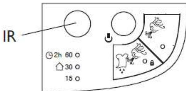
Um einen guten Signalempfang zum Lüfter zu erhalten, bleiben Sie in einem Radius von 3 Metern zum Gerät, wie in der Abbildung dargestellt.
