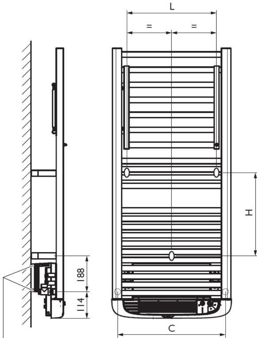
Für eine korrekte Installation: Stellen Sie sicher, dass die Kunststoffabstandshalter des Geräts an der Rückwand aufliegen.
