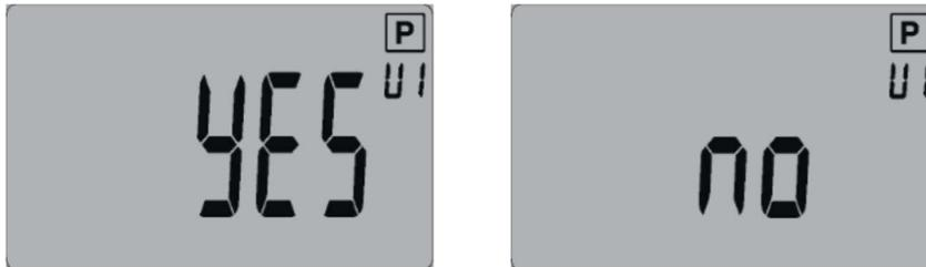
Durch das Drücken der Taste **OK** kann die Auswahl bestätigt werden. Bei der Bestätigung des siebenten Tages kehrt das System automatisch in den AUTO-Modus zurück (siehe Abschnitt „Automatischer Modus“) und das geänderte Programm wird angewendet.
