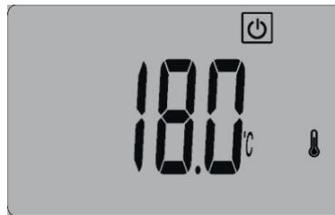
Werden die Tasten **OK**, **▶**, **+** oder **–** erneut gedrückt, wird einige Sekunden lang die Uhrzeit angezeigt.
