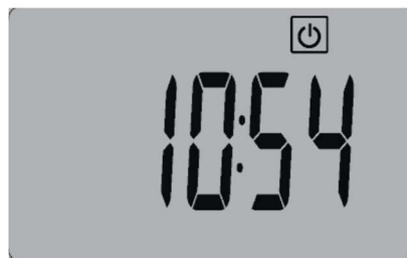
Um den Standby-Modus zu verlassen, muss die Taste (On/Off) gedrückt werden.
