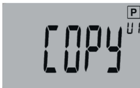
In diesem Modus kann der Bediener eventuell das Programm in den nachfolgenden Tag kopieren. Durch Drücken der Tasten **-** oder **+** kann „YES“ oder „No“ ausgewählt werden, um das Kopieren zu bestätigen oder nicht.
